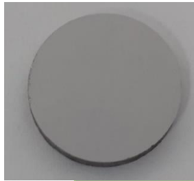
Aço carbono sem revestimento
